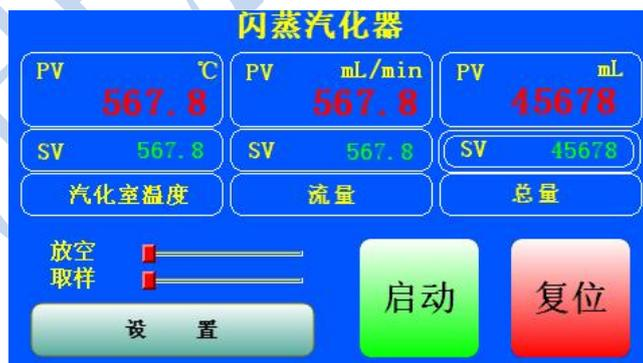
汽化室温度：PV 表示当前温度，SV 表示设置温度，用户可以修改：室温~200℃。
